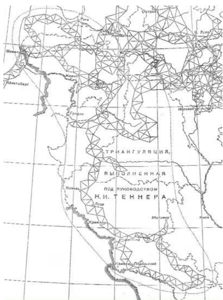
Рис. 1 – Фрагмент схемы триангуляции для топографических съемок, выполненной под руководством К.И. Теннера в 1816 – 1841 гг. [5]
